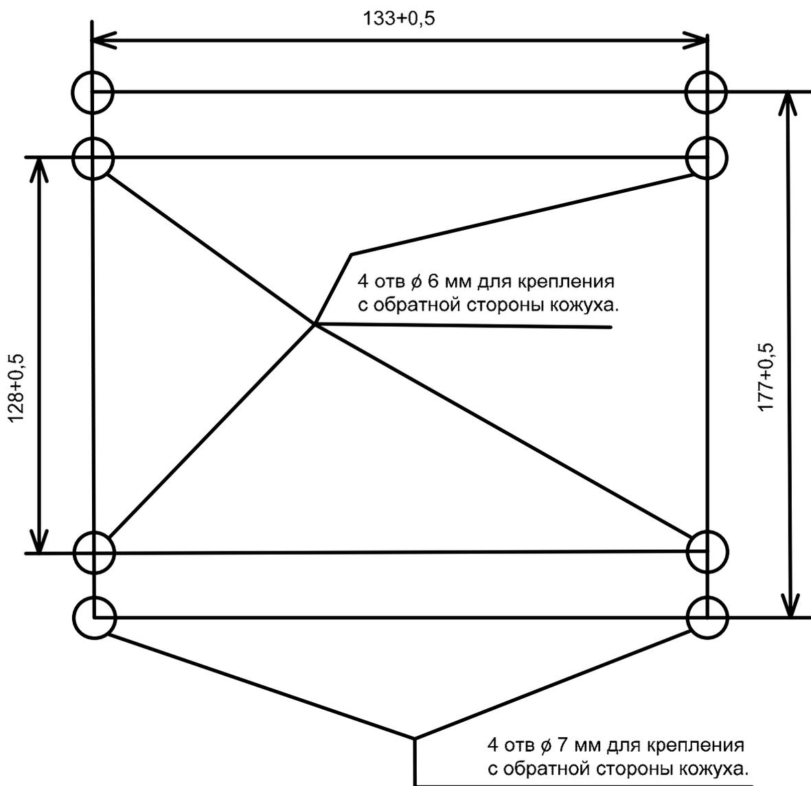
Рисунок 2 – Разметка щита для крепления БКТ-2
