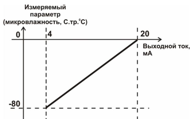
Рисунок 3.9 Пределы измерения влажности и выходной ток
