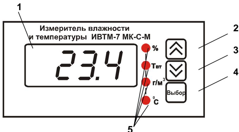
Рисунок 3.1 Вид передней панели прибора
