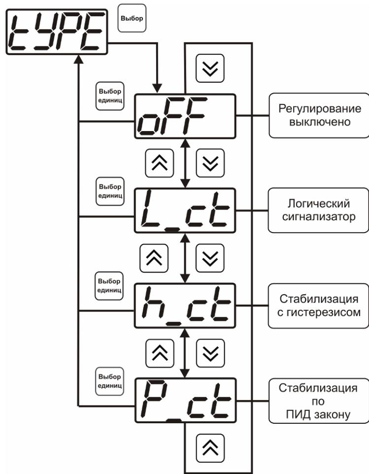
Рисунок 6.17 Выбор логики работы канала управления (реле)
