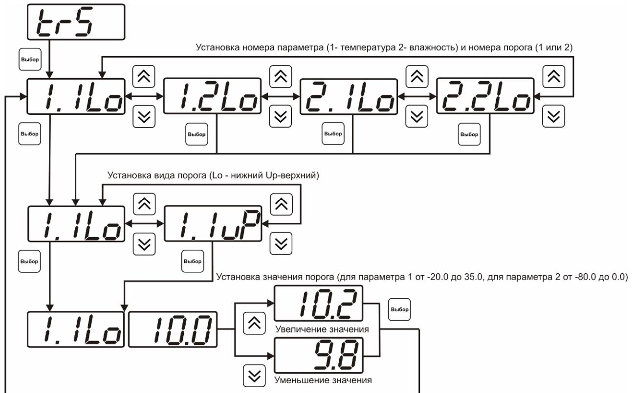
Рисунок 6.7 Задание порогов по температуре и влажности
