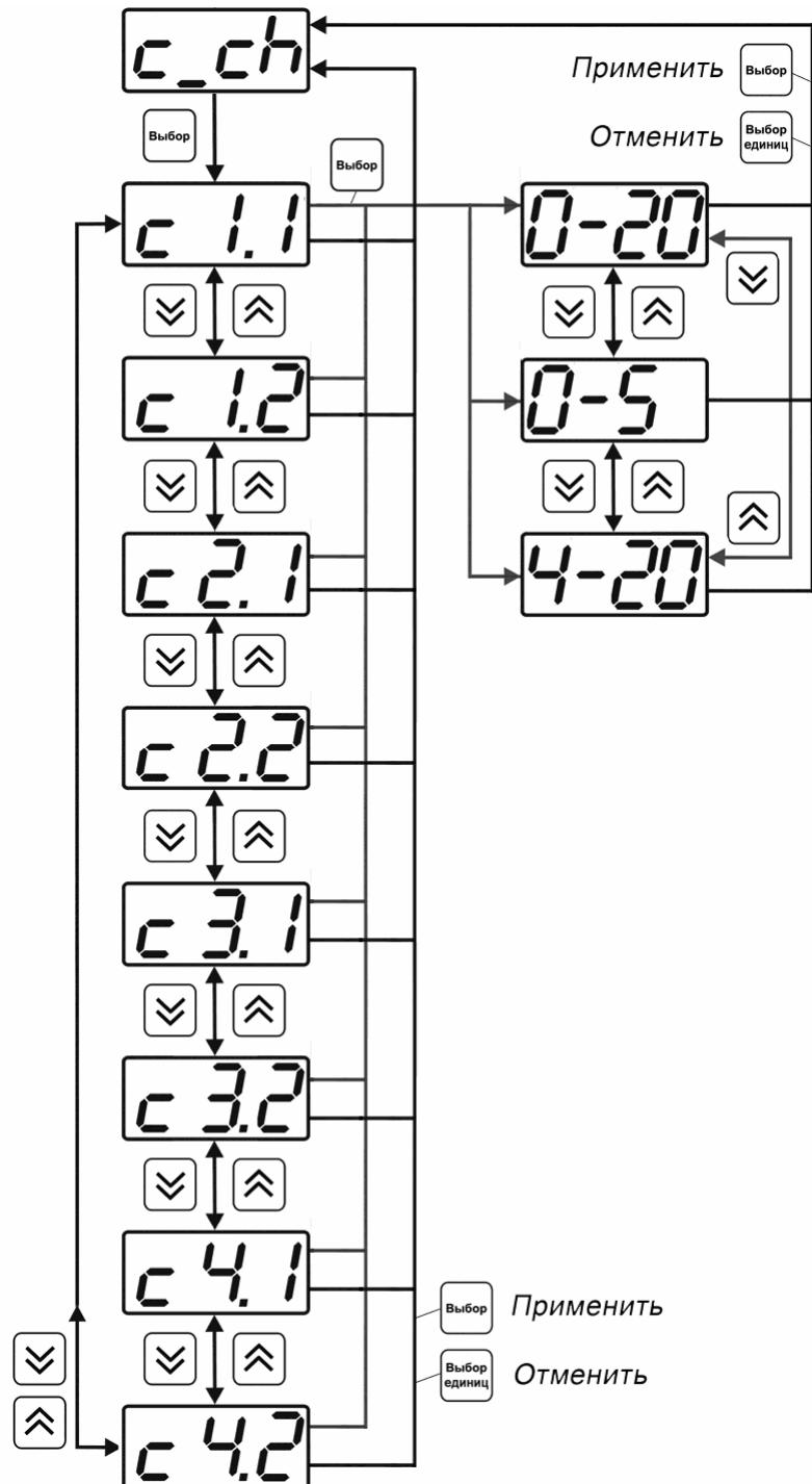
Рисунок 6.16 Настройка входного параметра канала управления (токовый)
