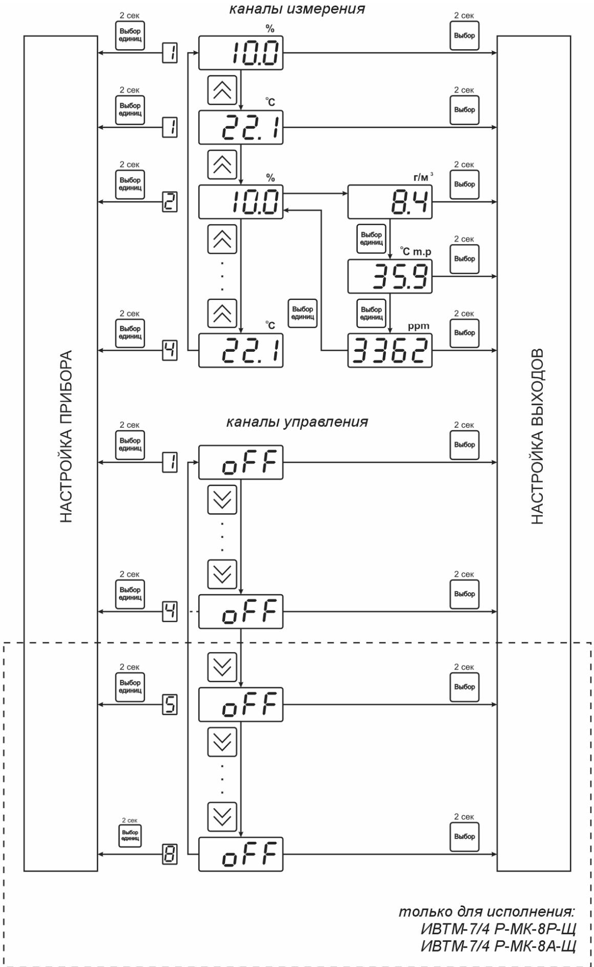
Рисунок 6.1 Режим “РАБОТА”
