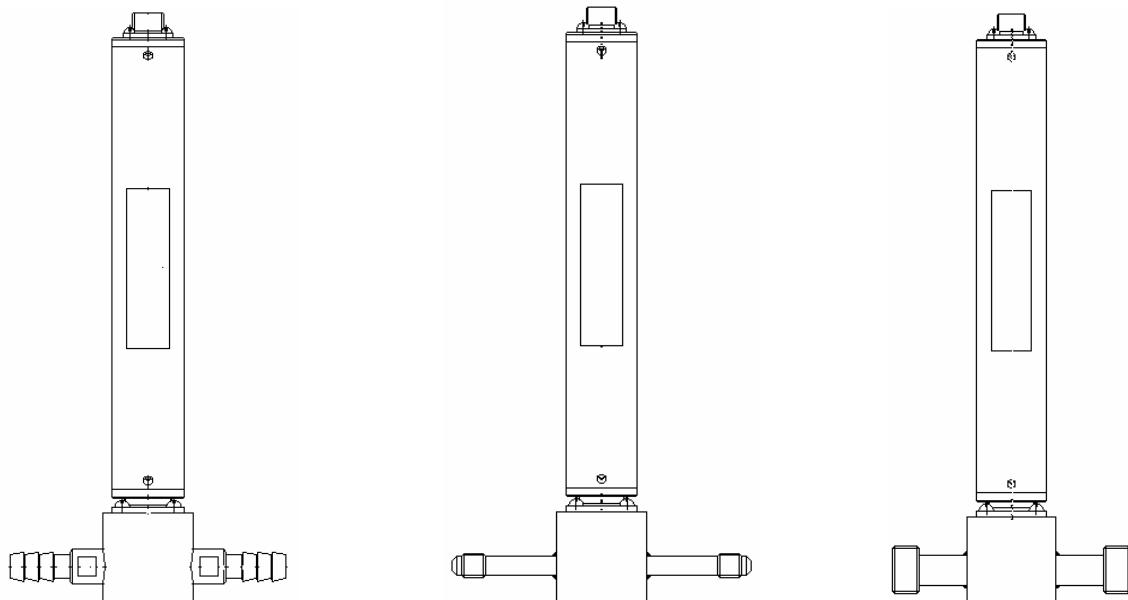
*Рисунок Б2 Преобразователи ИПВТ-03М-03-01, ИПВТ-03М-03-02-М8, ИПВТ-03М-03-02-М16 (по порядку слева направо)*
