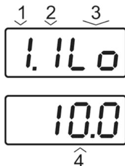
Рисунок 6.8. Расшифровка поля настройки порогов
