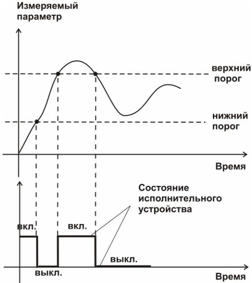
Рисунок 3.8 Функция вида  $f = \text{НП} + \text{ВП}$
