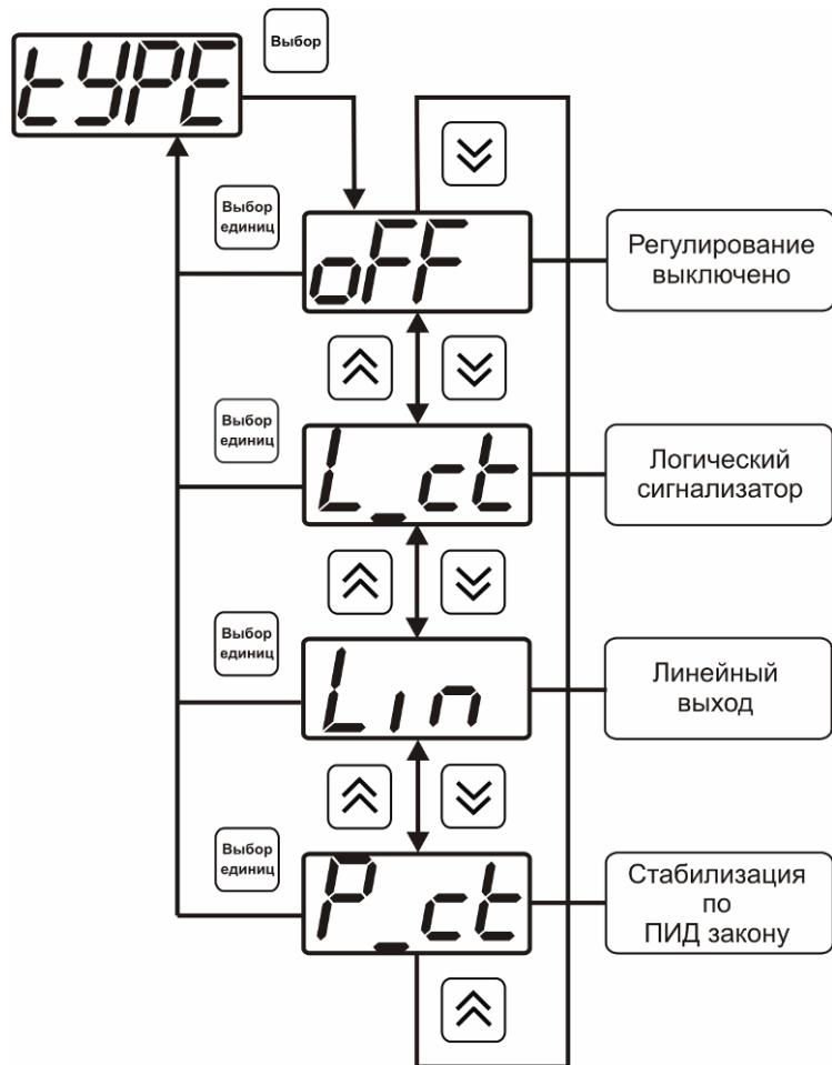
Рисунок 6.18 Выбор логики работы канала управления (токовый выход)
