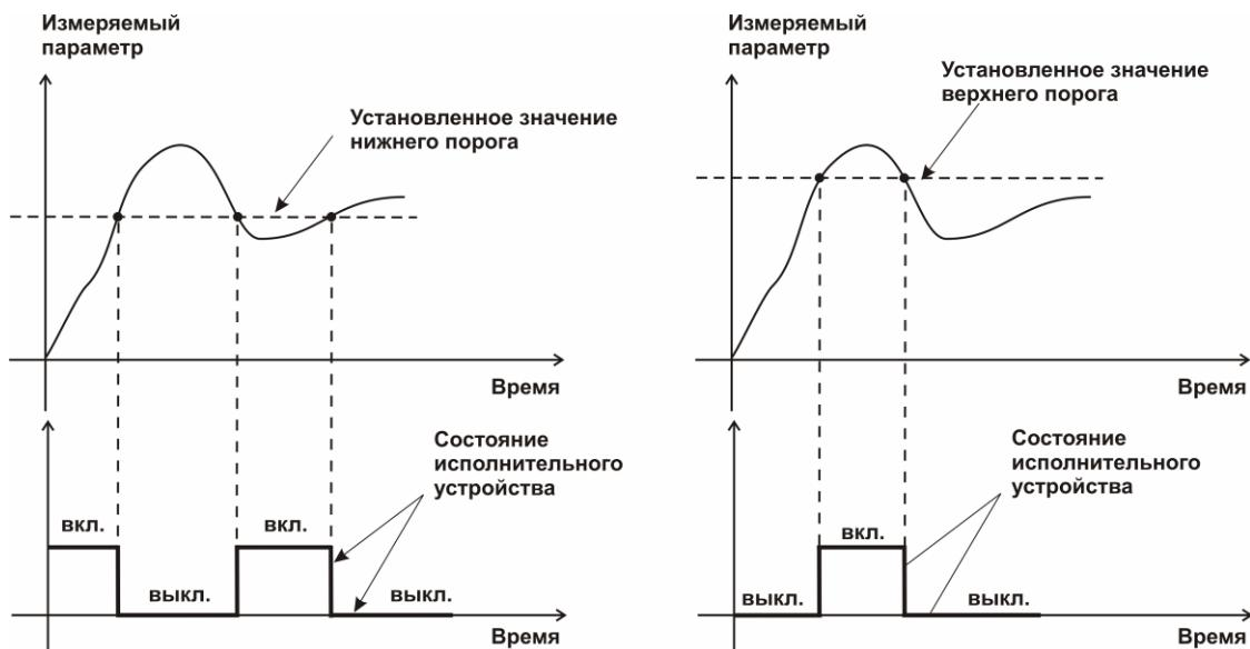
Рисунок 3.7 События: нарушения НП (слева), нарушение ВП (справа)
