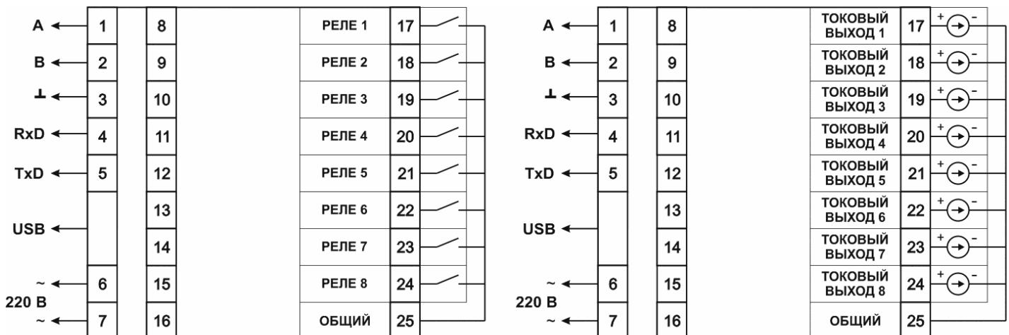
Рисунок 3.4 Схема подключений клемм задней панели,
