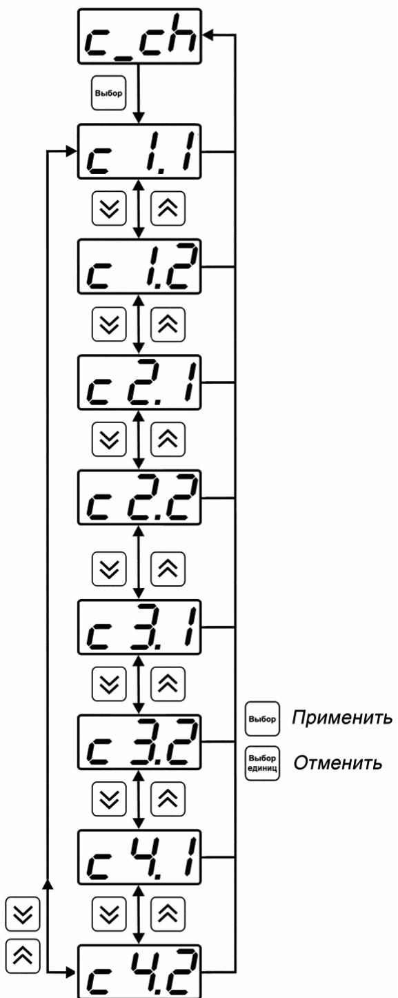
*Рисунок 6.15 Настройка входного параметра канала управления (реле)*
