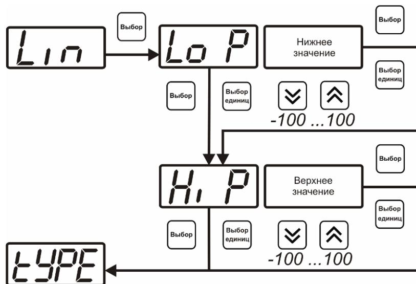
Рисунок 6.24 Настройка линейного выхода
