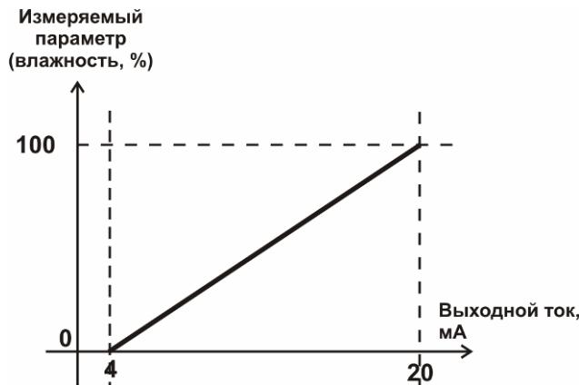
*Рисунок 3.11 Линейный выход 4...20mA по диапазону относительной влажности с границами 0...100%*
