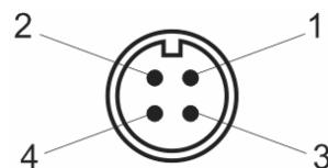
Рисунок 3.5 Разъем для подключения первичного преобразователя
