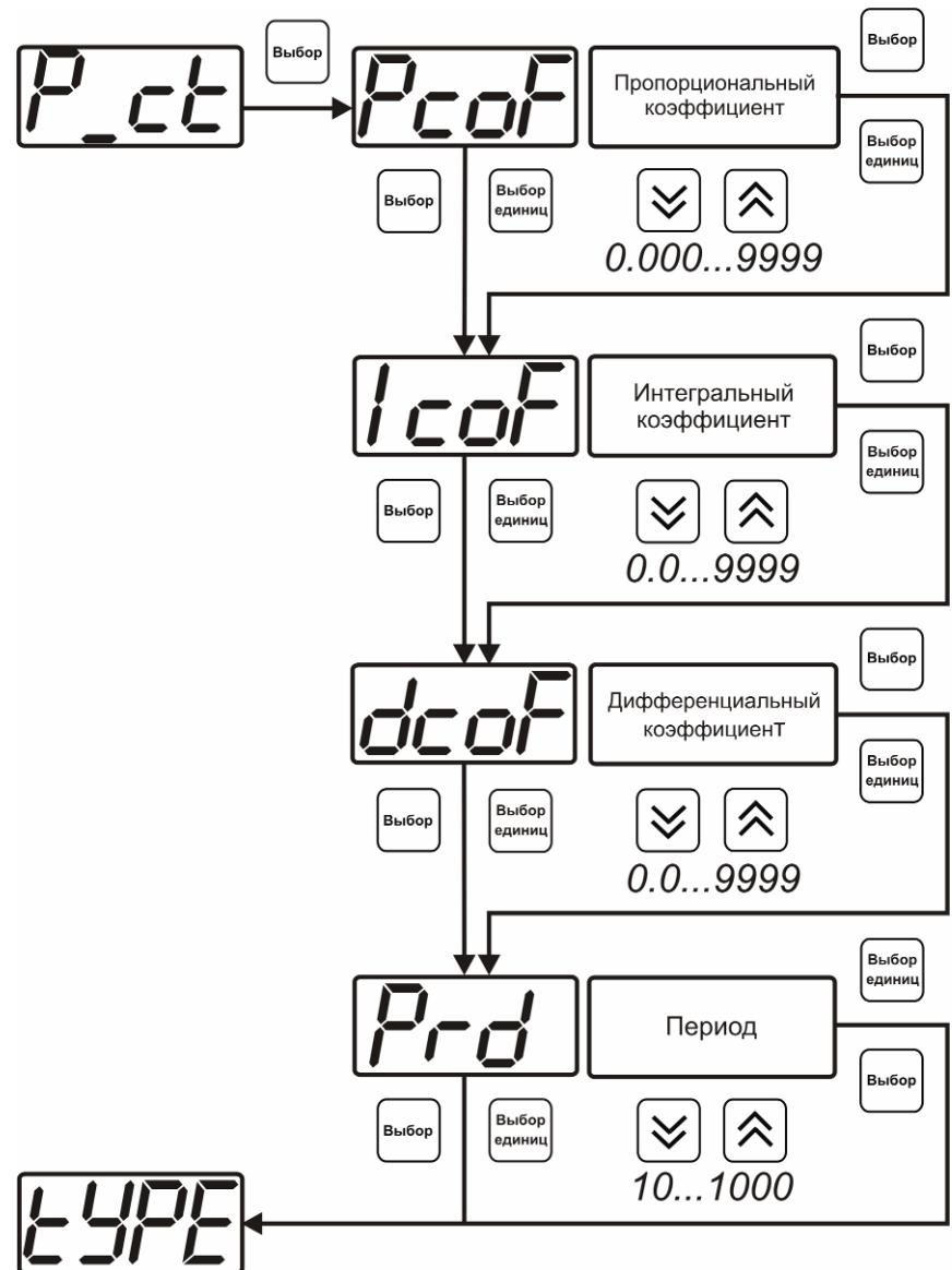
Рисунок 6.22 Настройка коэффициентов ПИД-регулятора (реле)
