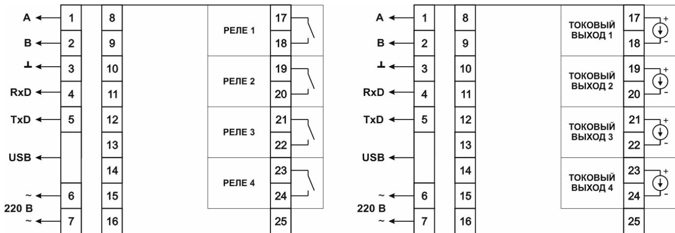
Рисунок 3.3 Схема подключений клемм задней панели,
