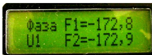
Второе вспомогательное окно. Фазы токов относительно указанного напряжения
