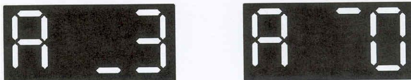
Рисунок 4 – Индикация сигналов замыкания и обрыва датчиков
