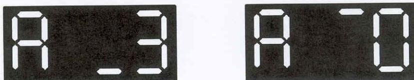
Рисунок 4 – Индикация сигналов замыкания и обрыва платиновых ТС
