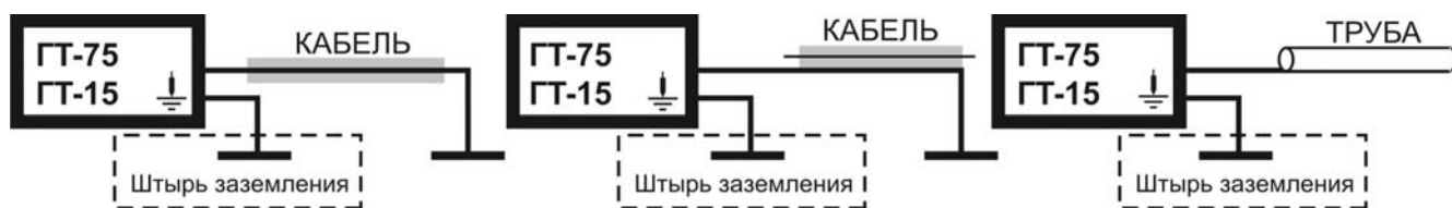
Рисунок 2.3.1 - Варианты подключения к коммуникациям:
