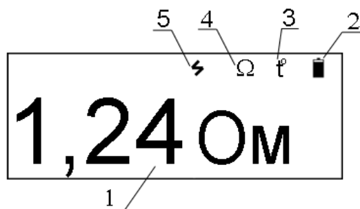
Рисунок 1.4.5 - Вид индикатора в режиме «Омметр».
