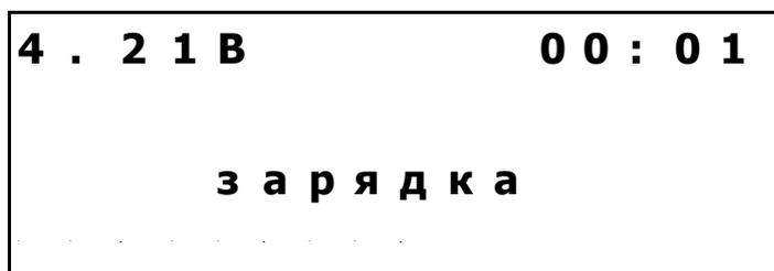
На дисплее в режиме зарядки отображается напряжение на батарее аккумуляторов, время от начала заряда (час:мин) и бегущая линейка.
