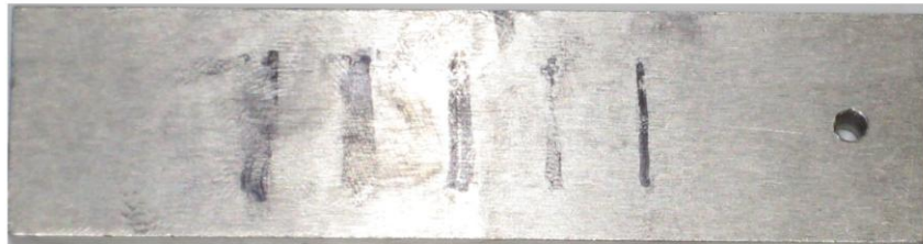
Рис. 7. Дефектограмма искусственных дефектов на образце МО-3
