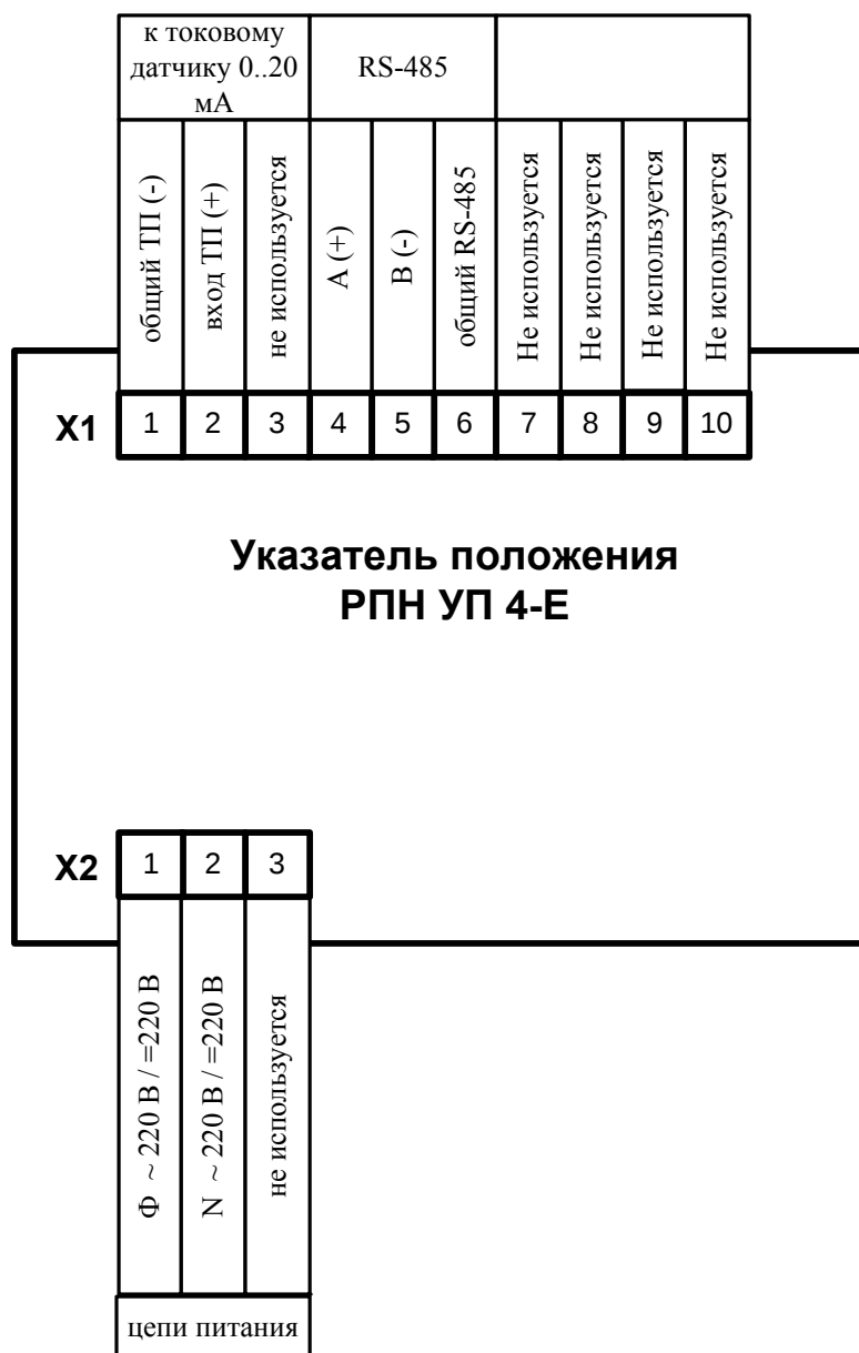
Рис. 3.1 Схема подключения УП 4-Е
