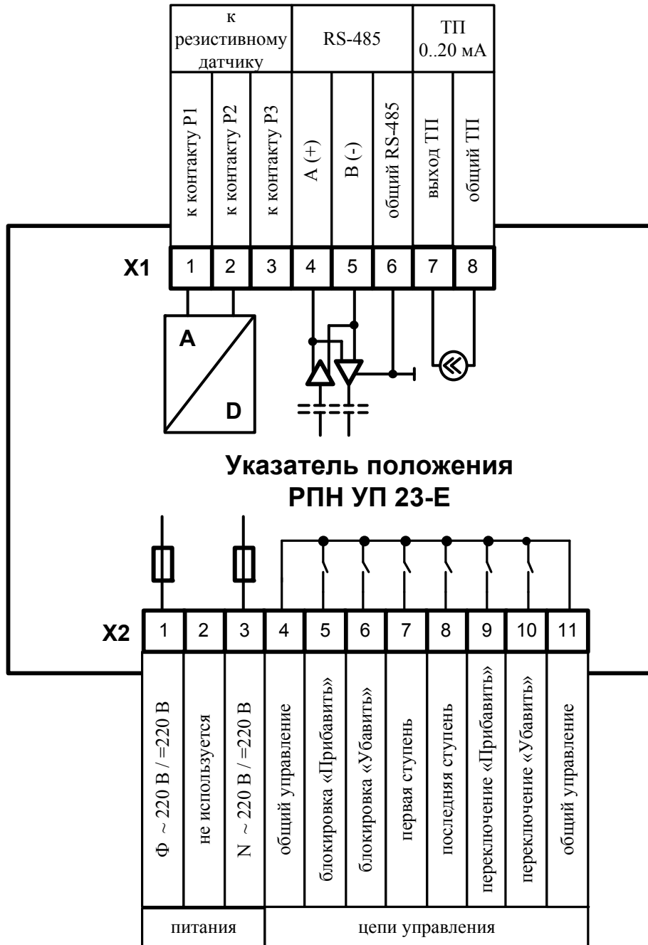
Рис. 3.1 Схема подключения УП 23-Е
