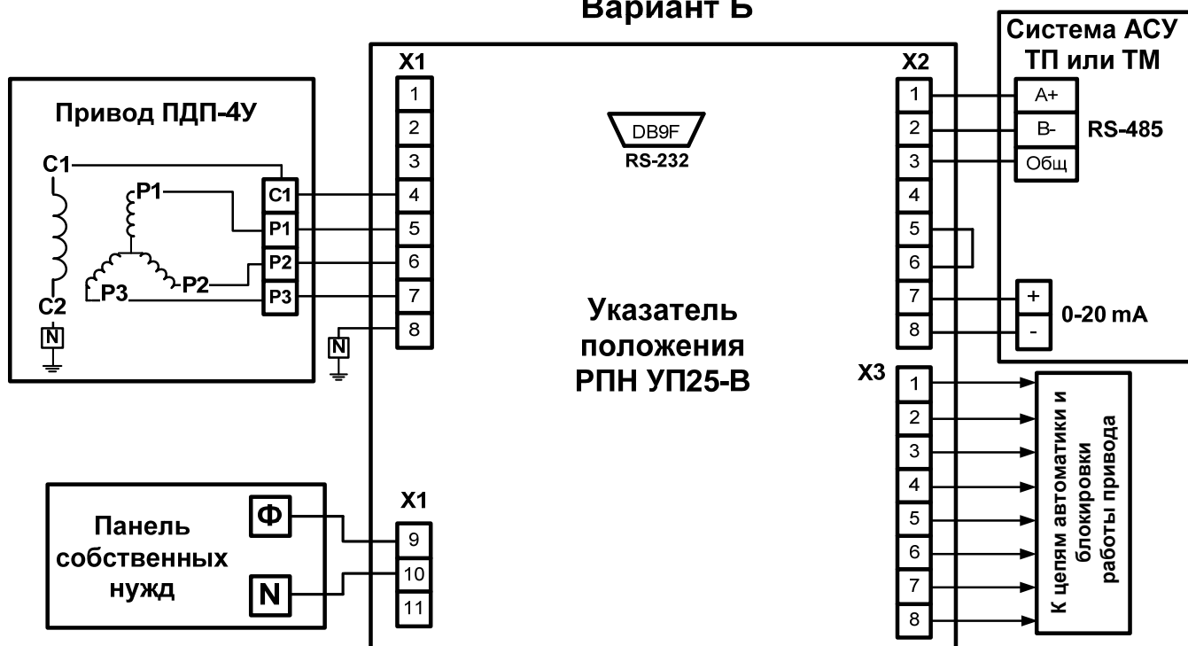
Рис. 4.1 Схемы привязки УП 25-В к приводу типа ПДП-4У.
