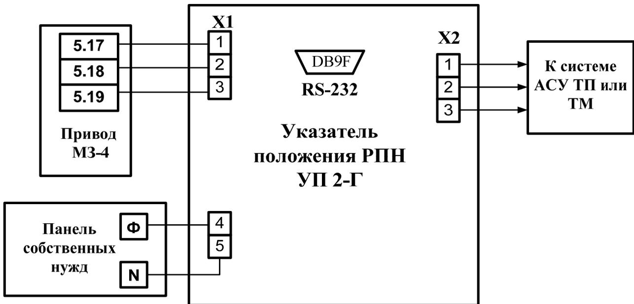
Рис. 4.1 Схема привязки УП 2-Г к приводу типа МZ-2, МZ-4.
