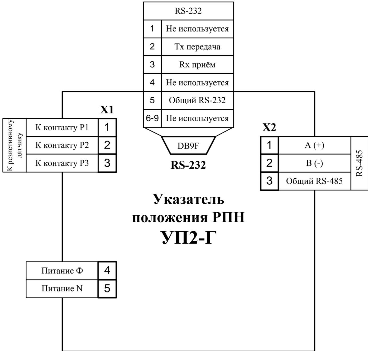
Рис. 3.1 Схема подключения УП 2-Г
