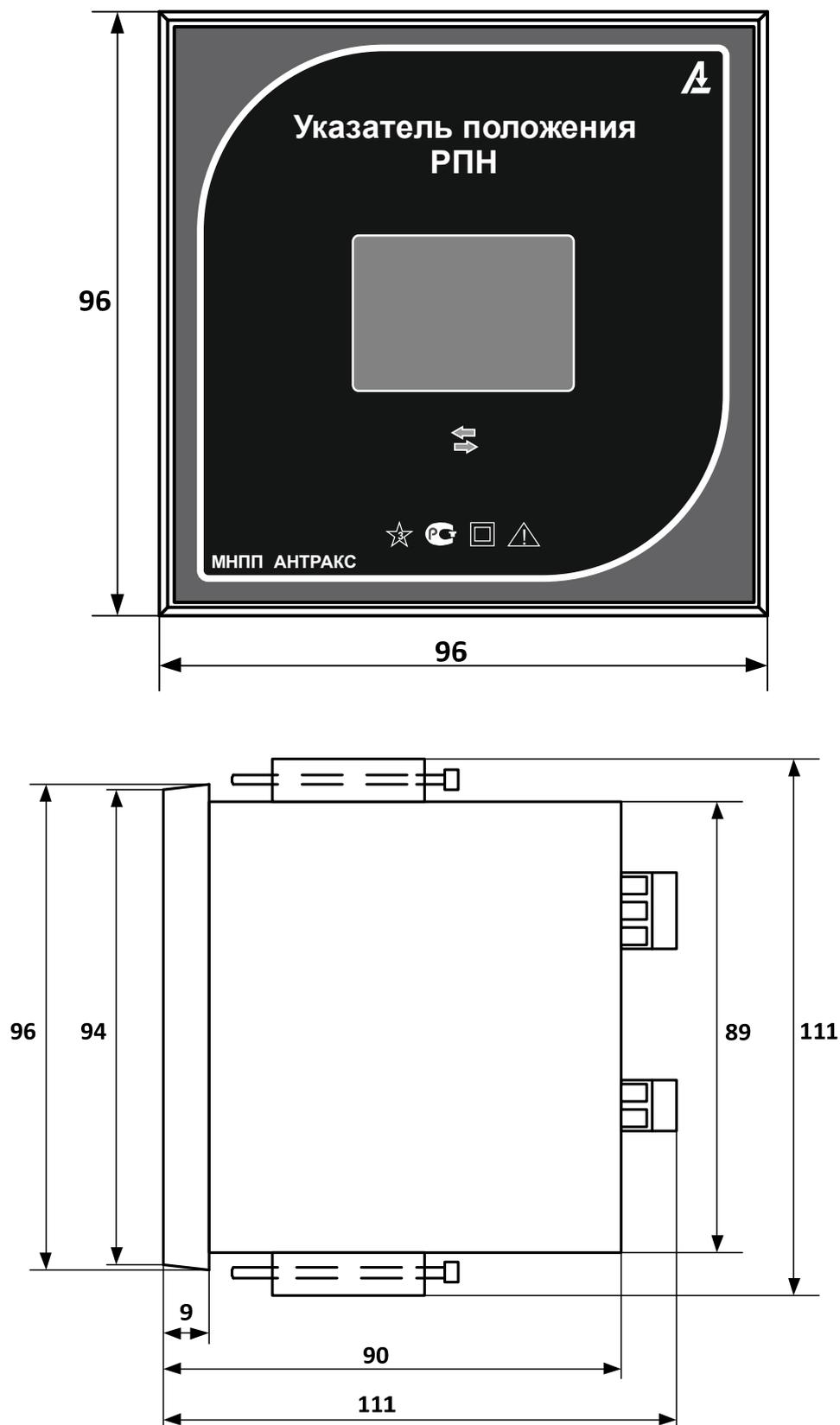
Рис. 1.1 Габаритные размеры щитового варианта указателя положения РПН УП 2-Г
