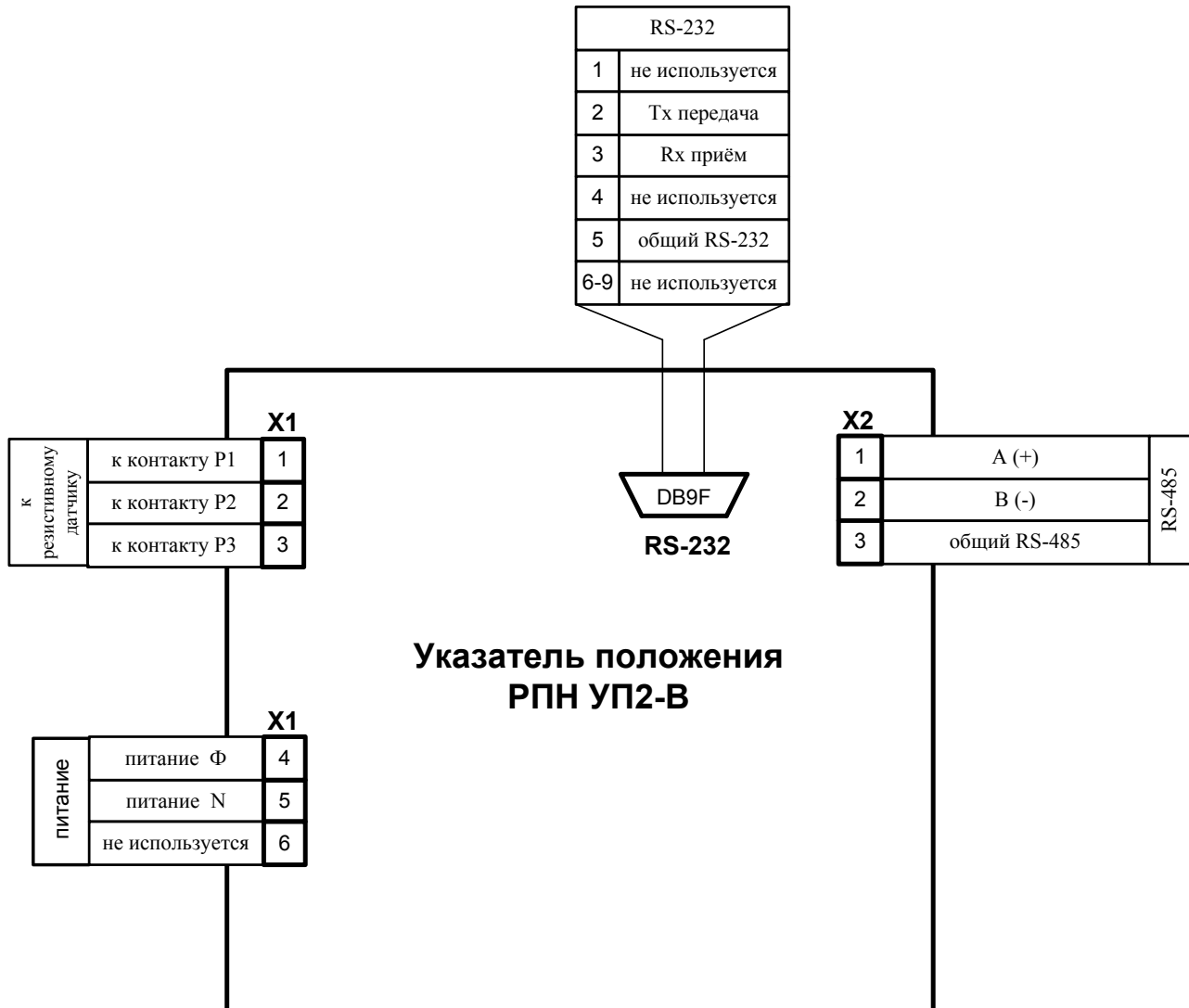
Рис. 3.1 Схема подключения УП 2-В
