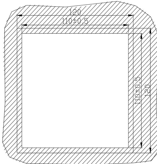
Рис. 2.1 Размеры вырубаемого окна в щите для установки щитового варианта указателя положения УП 32-В
