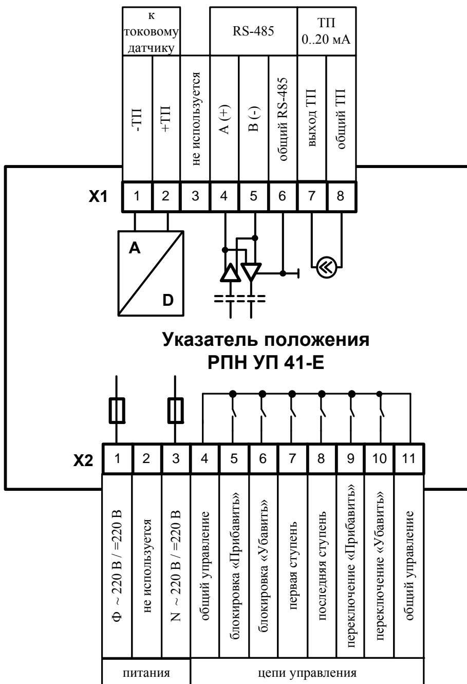
Рис. 3.1 Схема подключения УП 41-Е
