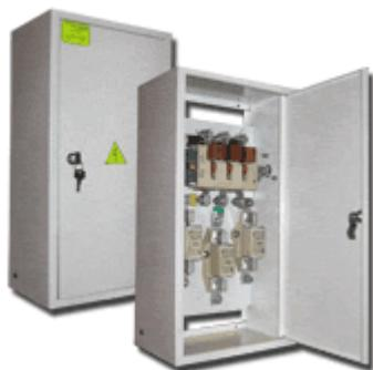
Ящики силовые с рубильником ЯРП и ЯПРП предназначены для нечастых (не более шести раз в час) коммутаций в цепях напряжением 380/220 В трехфазного переменного тока частотой 50 Гц с глухозаземленной нейтралью, а также для нечастых ручных переключений между основным и резервным вводами в цепях с напряжением 380/220 В трехфазного переменного тока частотой 50 Гц с глухозаземленной нейтралью. Ящики ЯРП и ЯПРП осуществляют также защиту отходящих линий от перегрузок и токов короткого замыкания.
